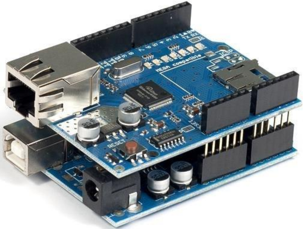
រូបភាព ៣.១៥៖ Ethernet shield (ខាងលើ) តភ្ជាប់ទៅនឹង Arduino UNO
