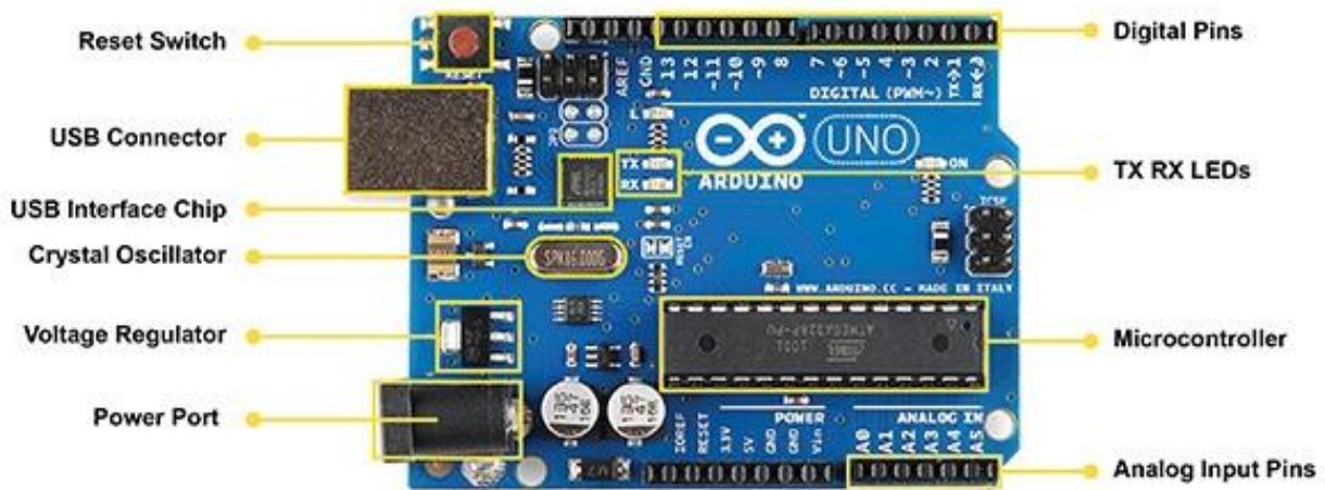
រូបភាព ៣.២ ៖ គ្រឿងផ្សំសំខាន់ៗរបស់ Arduino Uno
