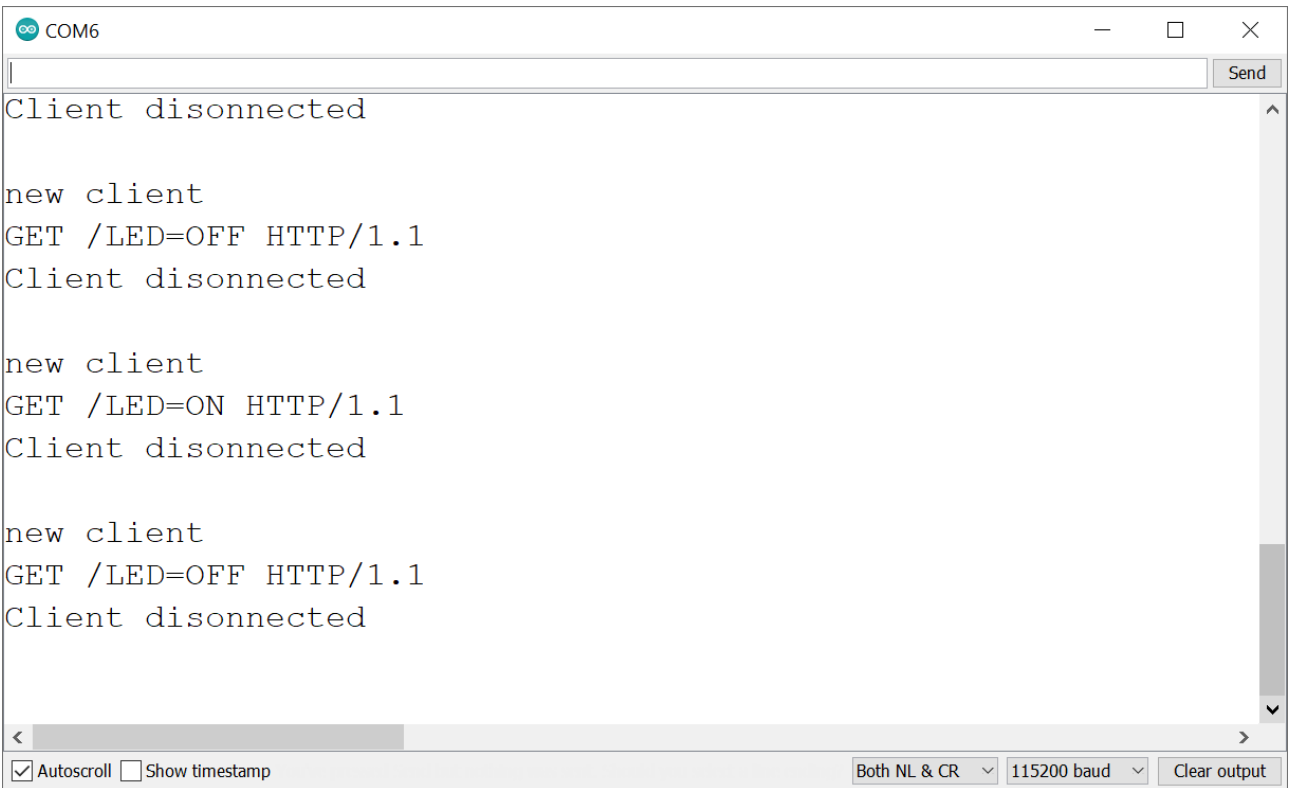
រូបភាព ៣.៨៥ ៖ Serial monitor របស់ NodeMCU បង្ហាញពីការចុចប៊ូ
