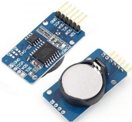
រូបភាព ៣.៥៣ ៖ Real-time clock module ( DS3231 )
